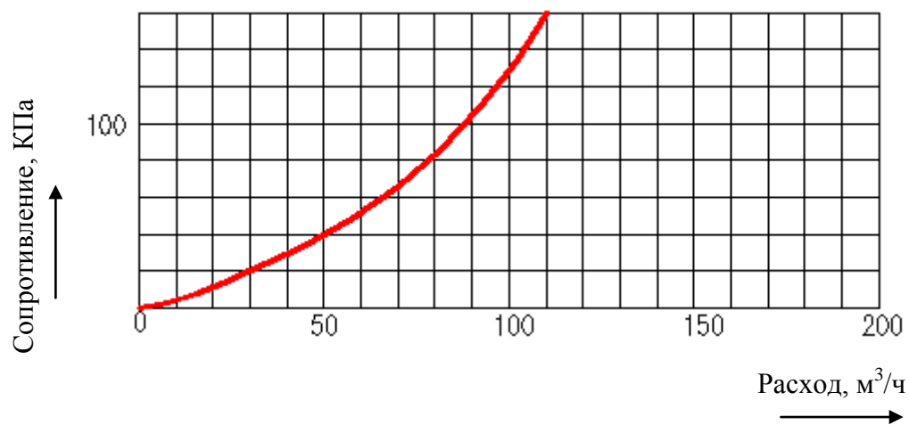
Зависимость гидравлического сопротивления маслоохладителя от расхода охлаждающей воды
