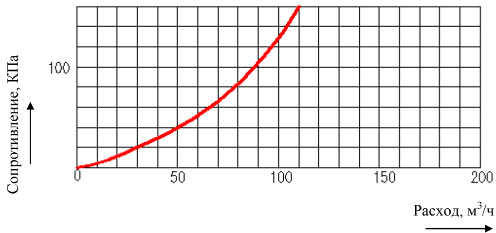
Зависимость гидравлического сопротивления маслоохладителя от расхода конденсата
